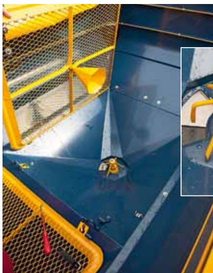
Abdeckroste halten Düngerklumpen zurück. Die Pyramide über dem Rührwerk führt den Dünger schonend seitlich an das exzentrische Rührwerk.
