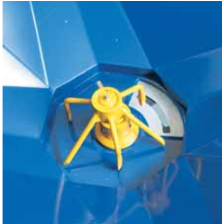
Das Rührwerk ist schonend zum Dünger. Für Feinsämereien und Schneckenkorn ist die schmale Schieberöffnung.
