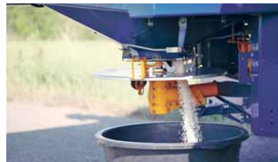
Zum Abdrehen und Entleeren von Restmengen gibt es eine Öffnung in der Streuscheibe und ein Führungsblech.
