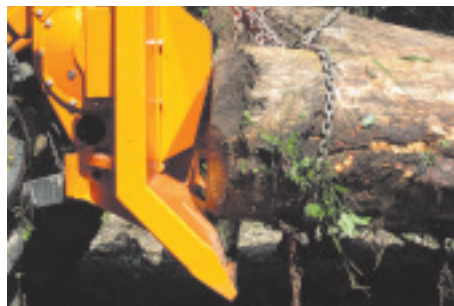
Eine steilere Winkelstellung bringt eine höhere Stabilität beim Zuzug.
