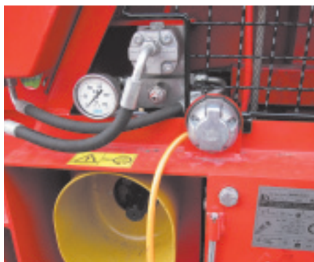
Ein fix eingebautes Manometer erleichtert die Störungssuche.
