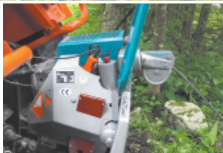
Die hoch liegende Seiltrommel ermöglicht eine horizontal befestigte Umlenkrolle.
