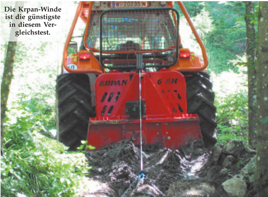
Das Hochheben von Blochen beim Poltern wird durch die flache Abwinke- lung des Rückeschildes erleichtert.
