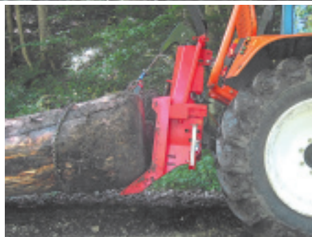
Die Unterlenker können an vier verschiedenen Positionen, der Oberlenker an zwei angehängt werden.
