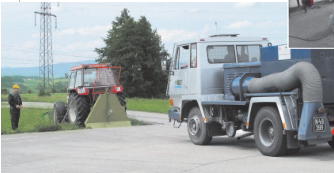
▲ Mit diesem Seilwindenprüfstand werden die maximale Zugkraft, die Überschneidung von Kupplung und Bremse sowie die Bremskraft ermittelt.
