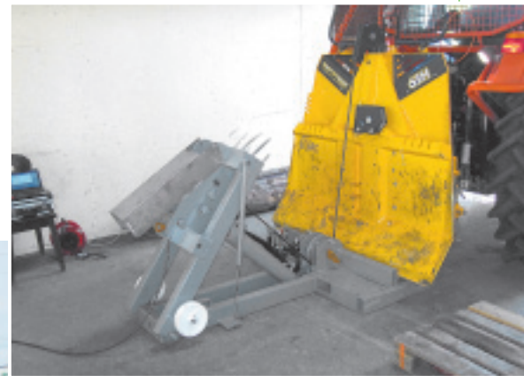
▲ Mit diesem Seilwindenprüfstand werden die maximale Zugkraft, die Überschneidung von Kupplung und Bremse sowie die Bremskraft ermittelt.
