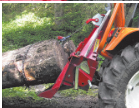
Bei hochgehobener Winde nähert sich das Schutzgitter der Traktorkabine.
