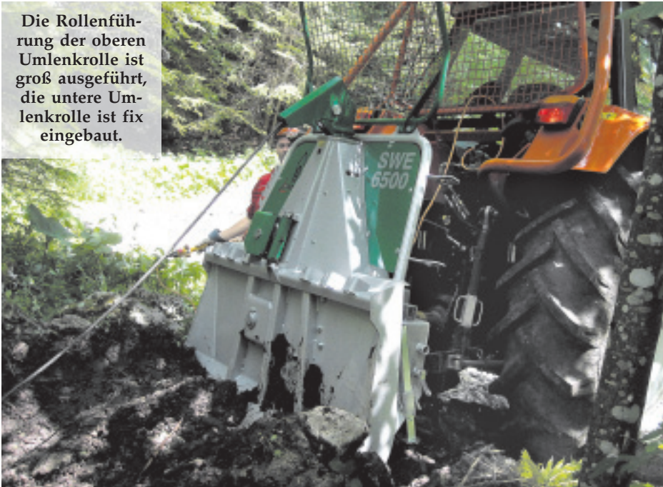
Die Interforst-Winde hat einen relativ großen Abstand von Unterlenkeranhängpunkt zur oberen Umlenkrolle.
