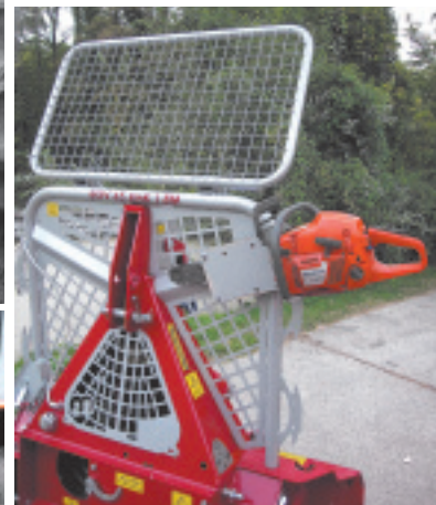
Praxisgerechte Halterung für die Motorsäge.
