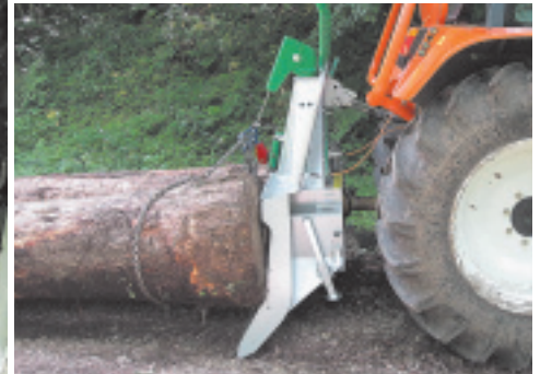
Die Interforst-Winde hat einen relativ großen Abstand von Unterlenkeranhängpunkt zur oberen Umlenkrolle.
