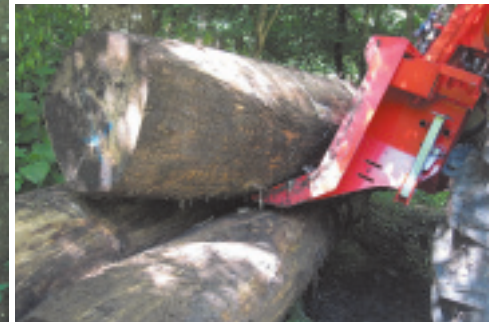
Das Hochheben von Blochen beim Poltern wird durch die flache Abwinke- lung des Rückeschildes erleichtert.
