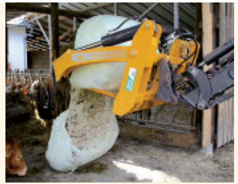
... der Ballen wird geteilt und die erste Hälfte abgelegt.
