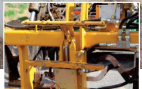
Eine Klemmvorrichtung mit aufgeschweißtem Metallzähnen hält Folie und Netz sicher zurück.
