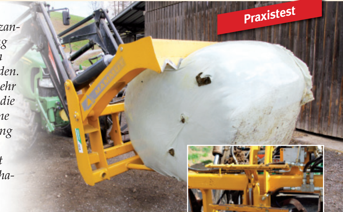
... der Ballen wird geteilt und die erste Hälfte abgelegt.
