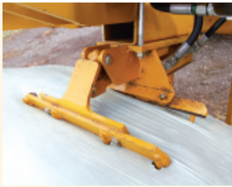
... Folie und Netz werden mit der Klemme fixiert ...
